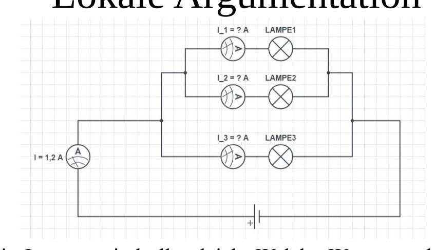
Die Lampen sind alle gleich. Welche Werte werden bei den Amperémetern gemessen?
